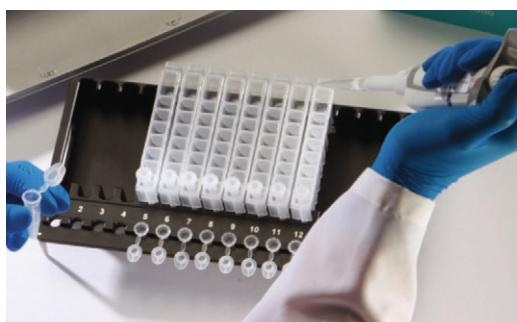
Vorbereitung Ihrer Proben, Zugabe in die vorgefüllten Kartuschen und Transfer der Kartuschenhalterung in das Maxwell® CSC.
